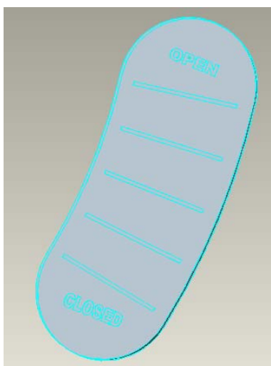
Figure 10.10 -----IGV Position Indicator
