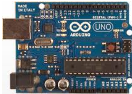
Figure 11 Arduino UNO motor controller
