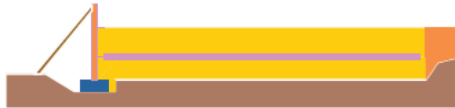
Fig. 1.8 : Continuation of a fill placement (source : MSE Wall Inspector's Handbook, Paul D. Passe 2000)
